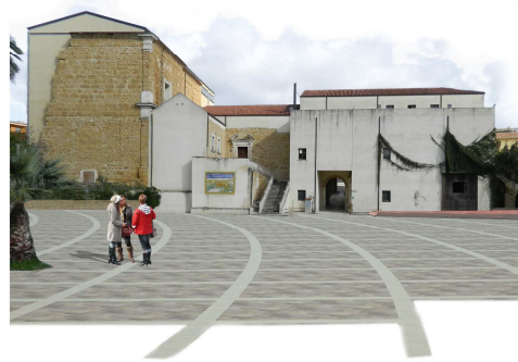
Pavimentazione in perlatto di Sicilia e Nerello_Vista retro del Palazzo del Gattopardo
